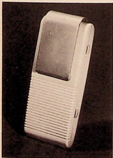
Bild 2. Empfänger des Pagemaster-Rufsystems. Der obere Knopf dient zum Abschalten des Ruftones, der untere zum Ein- und Ausschalten des Empfängers. Mit dem kräftigen Clip läßt sich das 63 x 92 x 25 mm große Gerät leicht in jeder Tasche befestigen
