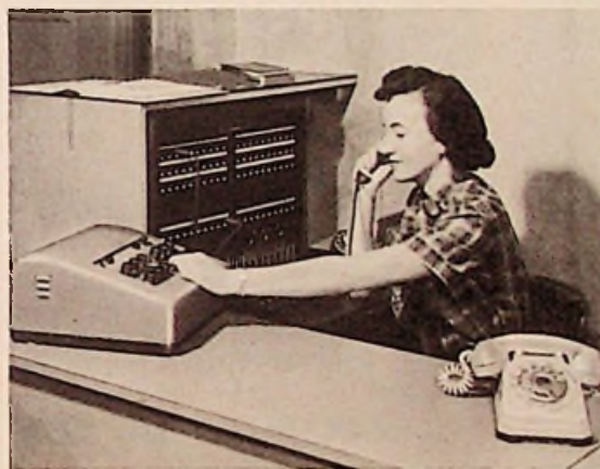
Bild 1. Modulationsgerät mit Zahlencodiereinrichtung für den Pagemaster-Sender in einer Fernsprechkabine
