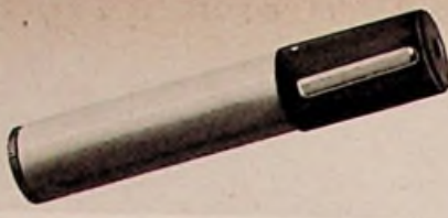
Bild 4. Der Multitone-Empfänger mit Clip wiegt einschließlich Batterie 140 Gramm und ist bei 25 mm Durchmesser 137 mm lang
