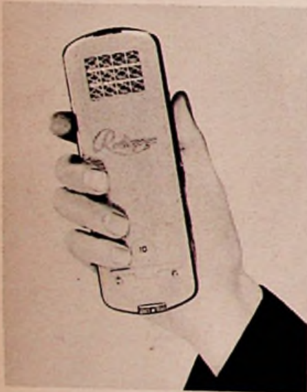
Bild 3. Radiopage-Empfänger mit kleinem Kristalllautsprecher
